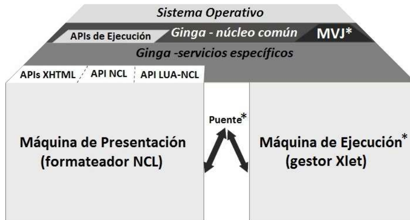
Figura 1 – Arquitectura de alto nivel del middleware Ginga. Los componentes de la arquitectura marcados con * se consideran opcionales a los efectos de este modelo de referencia.
